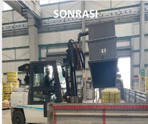
Resim 3. 360° dönebilen ataşman ile hurda demirin araca boşaltılması
