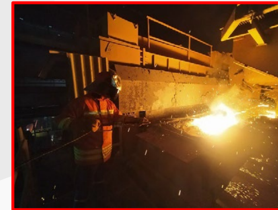
Şekil 4. Sürekli döküm operatörünün tandiş platformunda ölçüm alma görüntüsü
