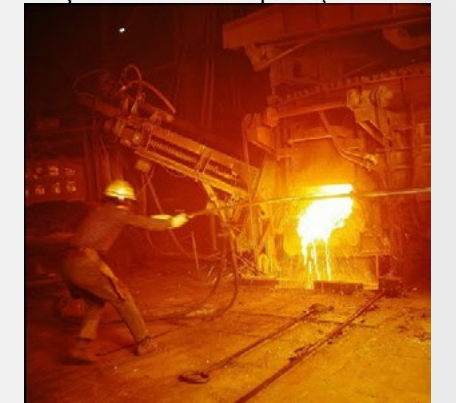
Şekil 11. Ark ocağı cüruf kapısından operatörün manuel olarak çelik sıcaklığı ölçümü [7].
