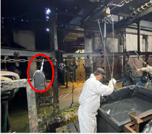
Şekil 2. Çalışma ortamına yerleştirilmiş pompa ve aktif karbon tüpü
