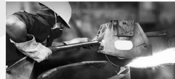
Şekil 16. Askılı Taşlama Operasyonu (Swing Frame Grinding Operation)
