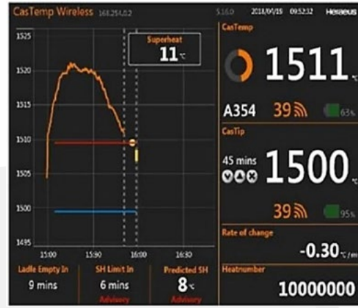
Şekil 13. Castemp SH Kontrol ekranı.
