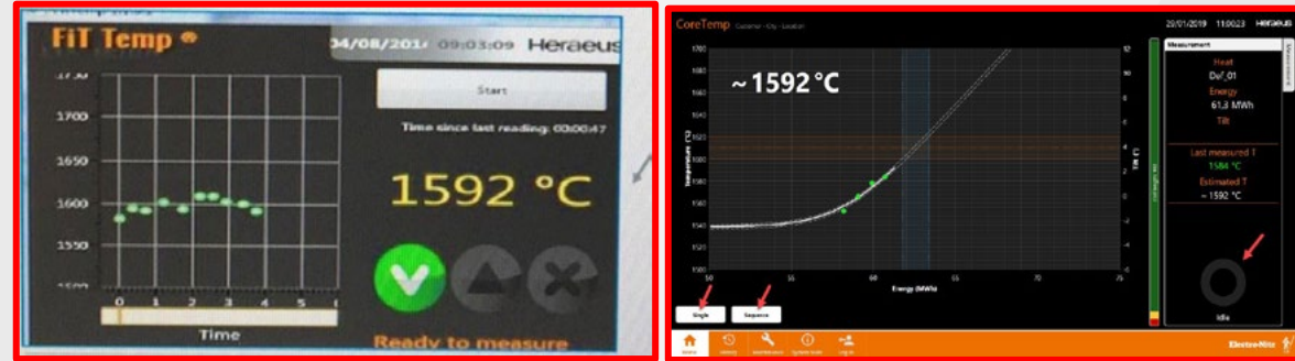
Şekil 3. Coretemp sisteminin PLC sistemi yardımıyla ölçüm sonuçlarının grafiğe aktarıldığı görüntü.
