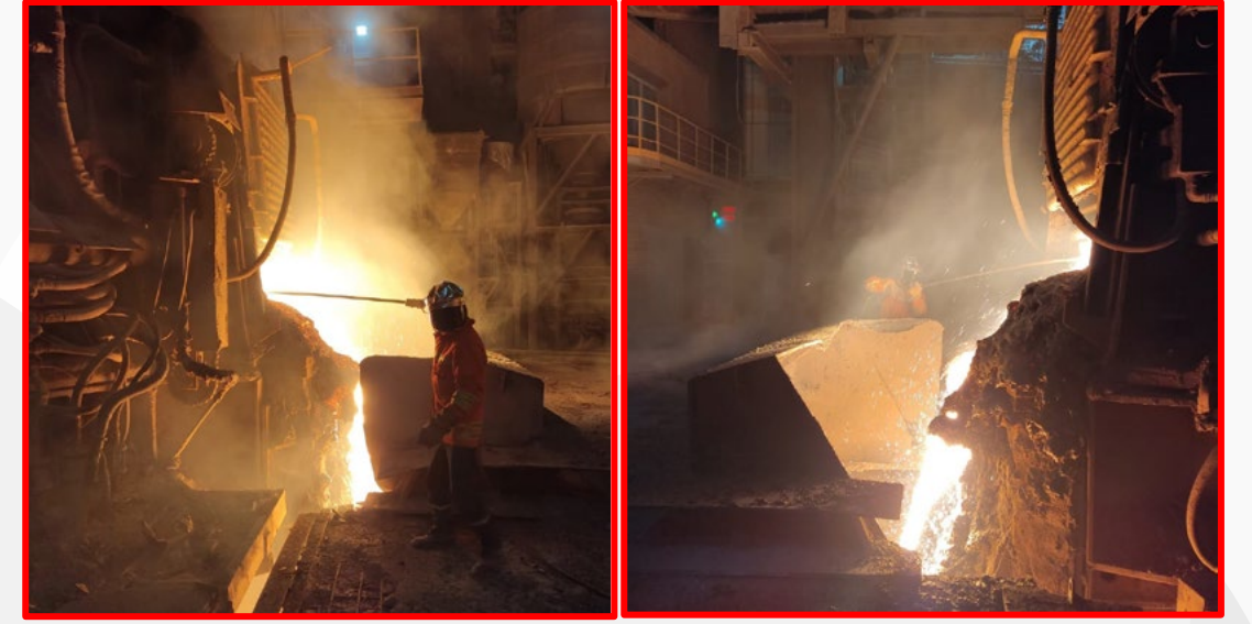
Şekil 1. EAO’nda personel tarafından sıcaklık ölçümü yapıldığı alanın görüntüsü.
