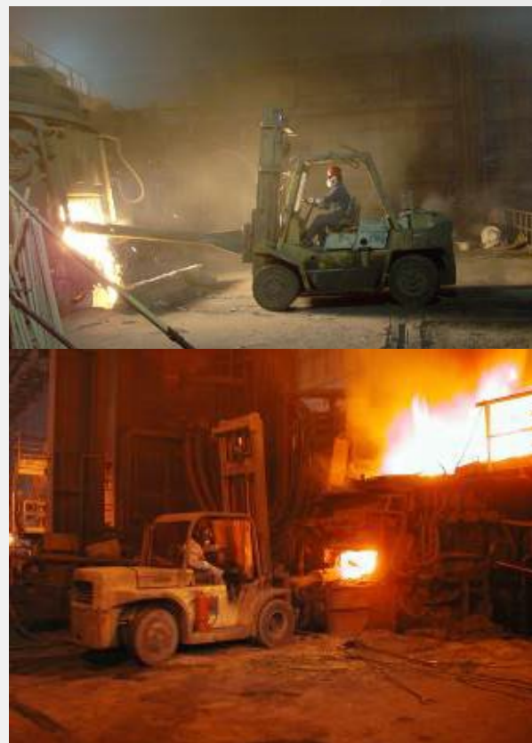
Fig 1 Slag door clearing operations
