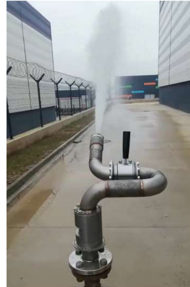
Şekil 10. Monitör basınçlı su testi
